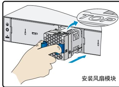
将风扇模块TOP标识朝向上方，捏住风扇模块把手，将风扇模块沿着插槽导轨水平插入，直到风扇模块完全进入插槽，并且与背板连接器端子接触良好。
