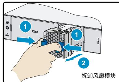
捏紧风扇模块的把手，同时沿着插槽导轨水平缓慢地向外拉出风扇模块。
